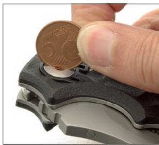
Der Klingengang lässt sich mit einer Münze einstellen. Interessant am zerlegten Messer sind die doppelten Gleitscheiben an der Klingennachse: Teflon plus Bronze auf jeder Seite.
