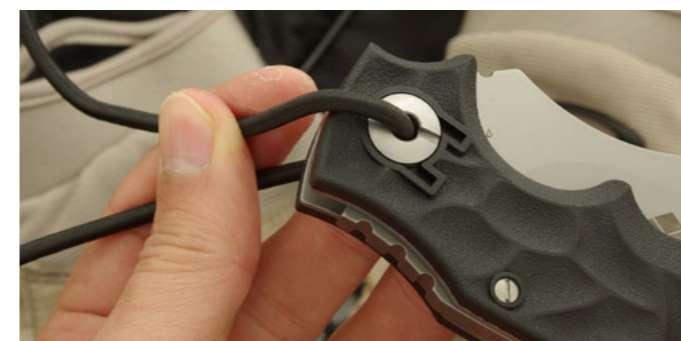
Super-Lösung: Die Fangschnur lässt sich auch durch die Klingennachse ziehen, wenn man den Clip an dieser Seite montiert.
